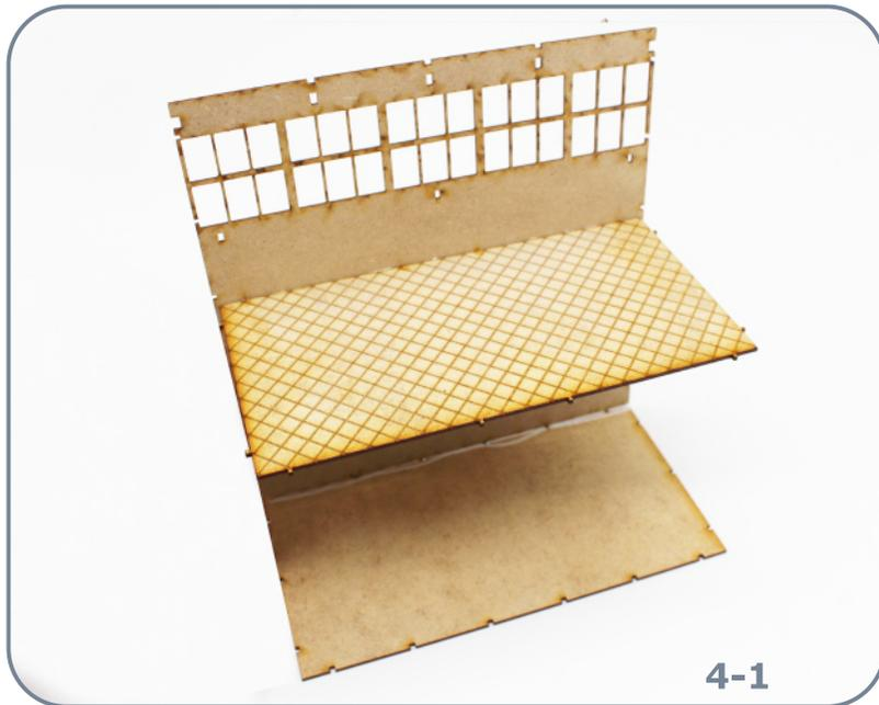
Die Frontwand mit der Fundamentplatte, dem Obergeschoss und der Seitwand verkleben.
