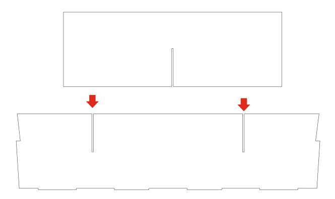
Beide Stabilisierungswände einstecken und Rechtwinkelig verleimen
