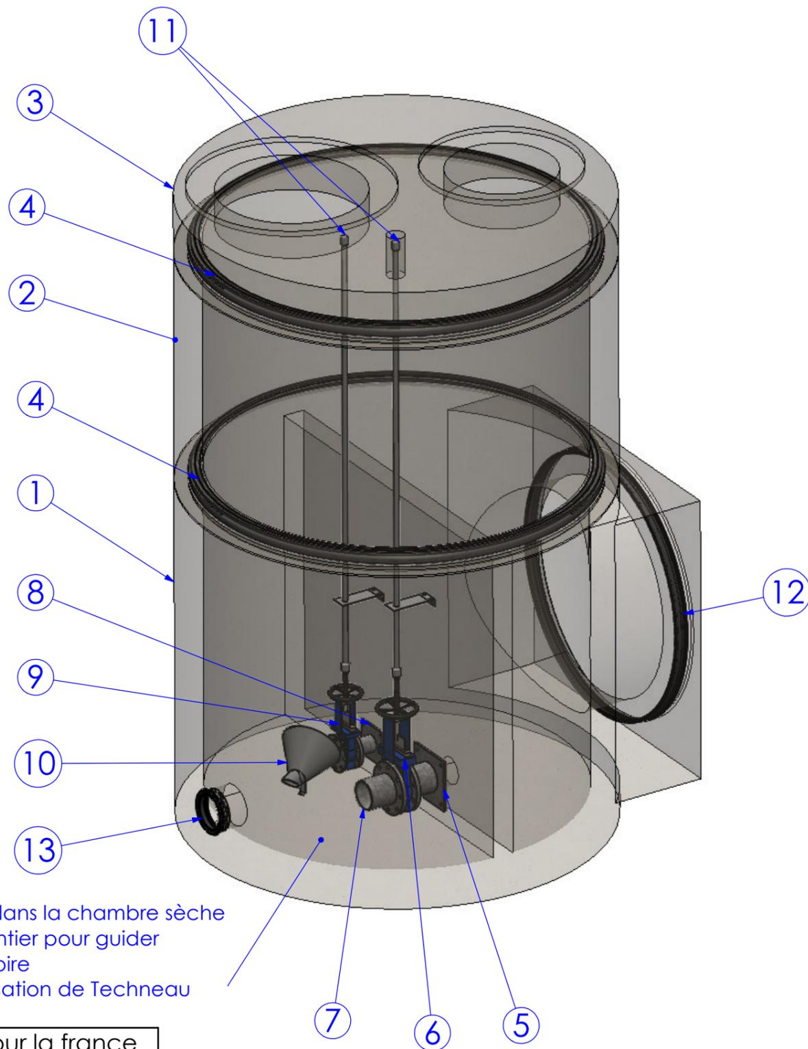
Béton de forme dans la chambre sèche à réaliser sur chantier pour guider les flux vers l'exutoire selon les préconisations de Techneau
