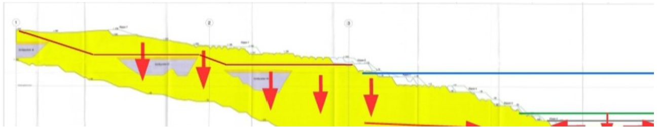
Abb. 2: Schnitt durch Innenkippe, Tagebau und Gewinnungsböschung. Die beige, graue u. grüne Linie zeigen den Rückverfüllungsraum, die blaue den Seespiegel. Durch Rücknahme der Abraummassen (oberhalb der hellbraunen Linie links im Bild) Schaffung landwirtschaftlicher Flächen auf Umlandniveau. Die roten Pfeile zeigen die Krafteinwirkung der Kippenmassen und die stabilisierende Wirkung der rückverfüllten Massen.
