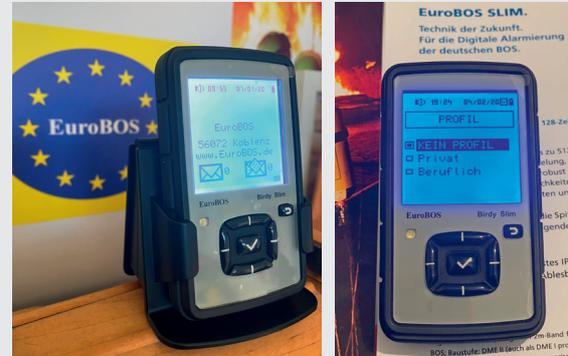
128 Hauptadressen / RIC | Wasserdicht – IP67 | 128-Zeichen-Multi-Color-Display | integrierte BOSKRYPT / AES-Verschlüsselung | robust | BOS-Zulassung DME II 61/20
