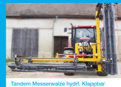
Tandem Messerwalze hydr. Klappbar
