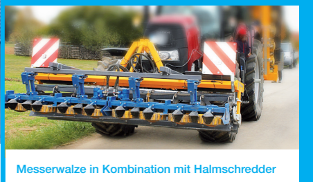
Tandem-Messerwalze mit optionalen Beschwerungsgewichten
