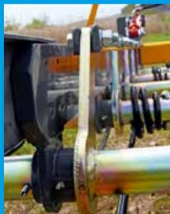
Hydraulische Verstellbarkeit der Zinkenstellwinkel – von schleifend/schleppend bis aggressiv
