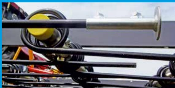
„Harrow Scratcher“ Schneidscheiben als Aufsatz für Zinken – bessere Schneidwirkung, beispielsweise für Saatbeetvorbereitung im Frühjahr
