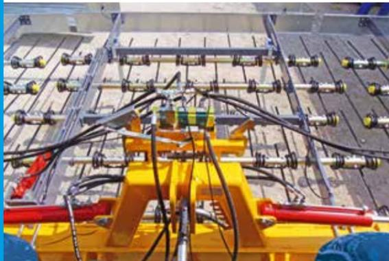
Serienmäßige Ausstattung mit doppelt entsperbaren Rückschlagventilen bei Hydraulikzylindern
