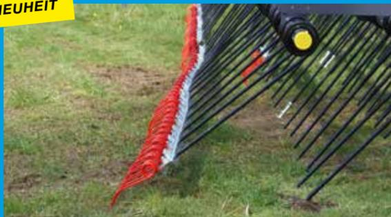
Zusatzoption „Harrow Carrier“, feine Hackstriegel als Aufsatz auf Striegelzinken – variabel an Zinken von aggressiv bis schleppend einstellbar
