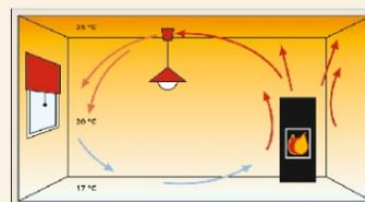
Die Konvektionswärme eines gewöhnlichen Kaminofens steigt in den oberen Teil des Zimmers, und die Hitze staut sich auf unangenehme Weise in der Nähe des Kamins. Auch wird die Wärme nicht gespeichert, sondern entweicht über den Schornstein nach außen. Bei den Temperaturen auf den Abbildungen handelt es sich um Leitwerte.
