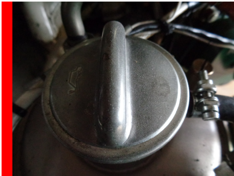
Öleinfülldeckel ist farblich nicht markiert / Oil filler cap is not color coded
