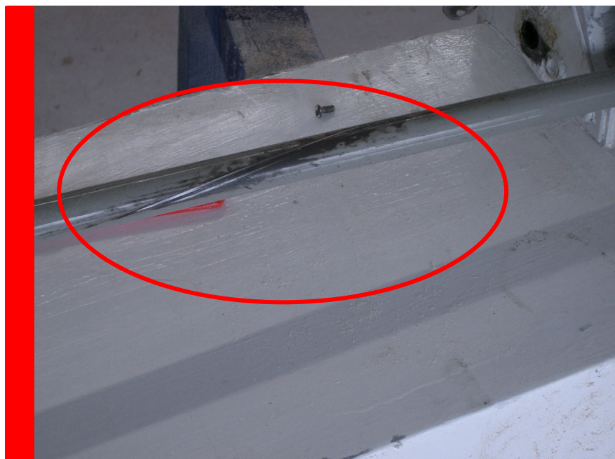
Querruderschubstange vom Steuerseil angesägt / Aileron push rod sawn off the control cable
