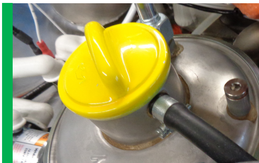
Öleinfülldeckel farblich markiert / Oil filler cap color coded
