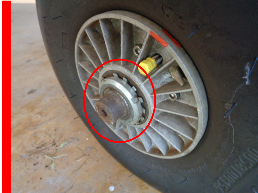
Radmutter mit Fasse nach außen montiert / Wheel nut mounted with chamfer to the outside
