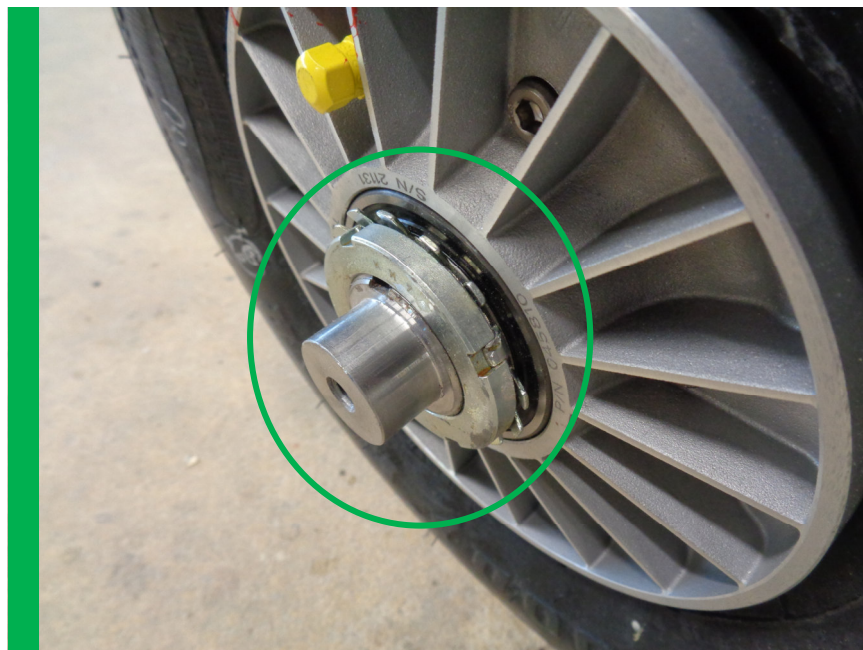
Radmutter mit Fasse zum Radlager montiert / Wheel nut with chamfer fitted to the wheel bearing
