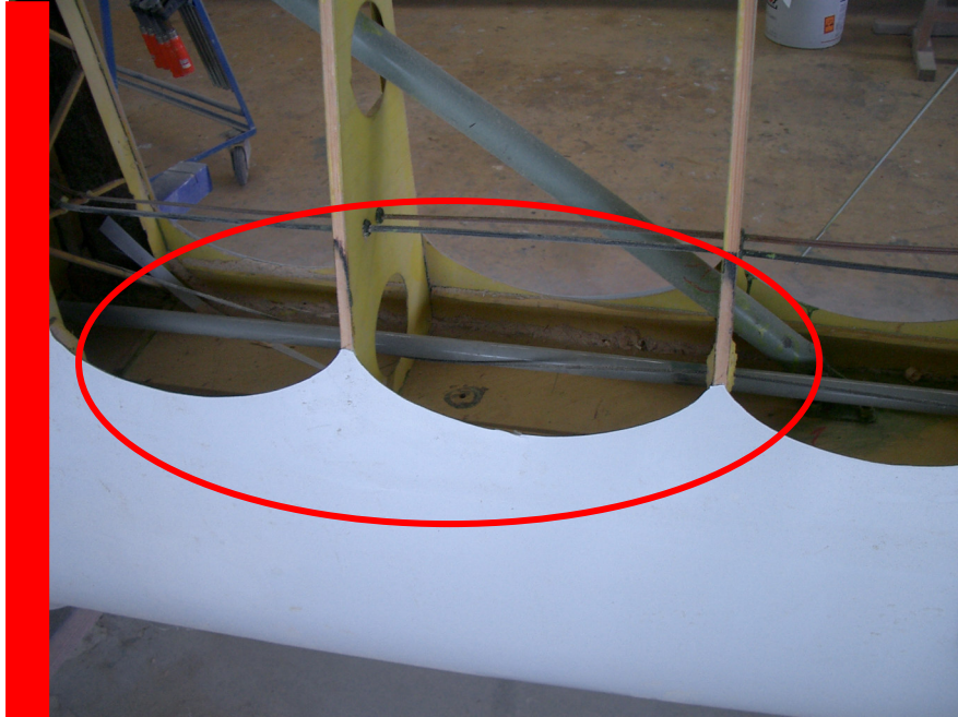
Steuerseil für Störklappen um die Querruderschubstange herumgelegt / Control cable for spoilers around the aileron push rod
