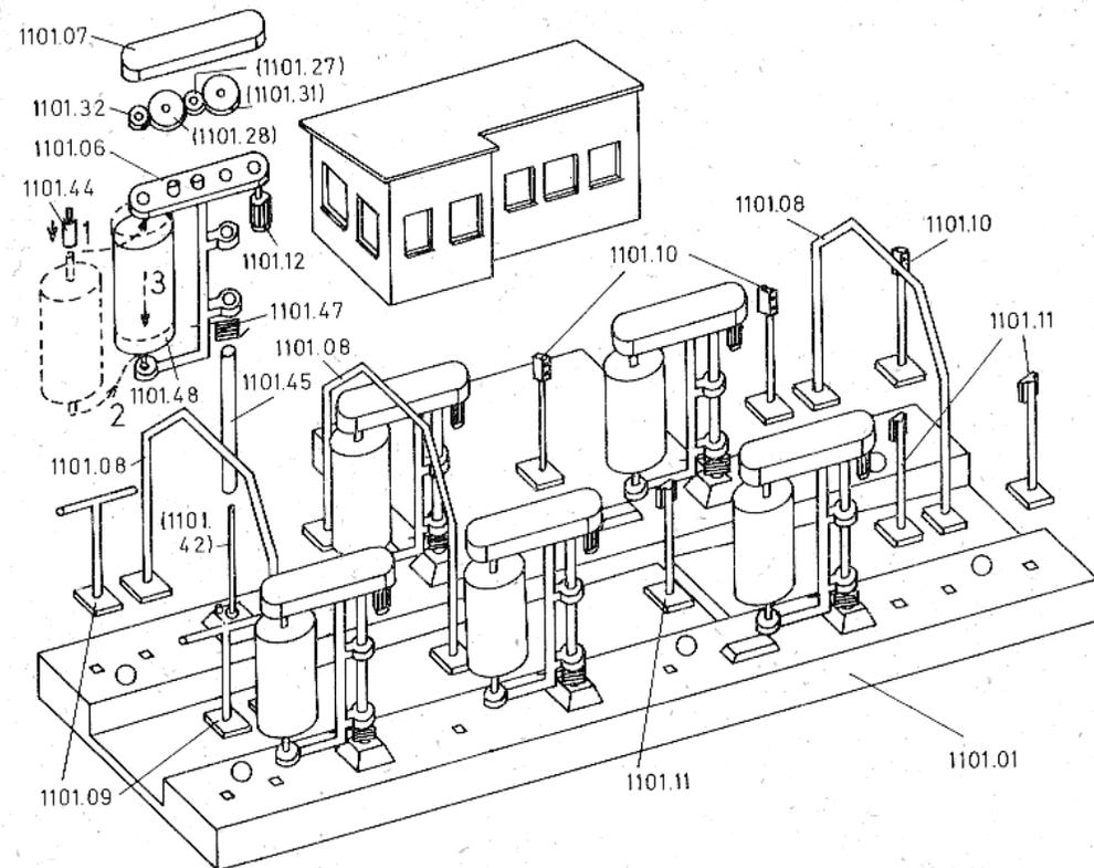
1. 6 Säulen 1101.45 in die Bohrungen mit Hilfe des beigelegten Röhrchens einklopfen und Federn 1101.47 mit dem kurzen Schenkel voraus aufschieben.
