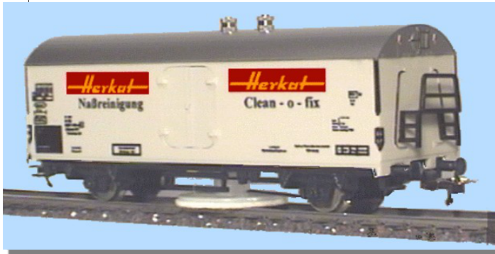
1305 Schienenreinigungswagen mit rotierender Reinigungsscheibe. Zum Füllen mit SR 24. Auf dem Dach je eine Einfüll- und Regulierverschraubung. Zwei bewegliche Doppeltüren, dahinter der transparente Reinigungsmittel-Tank., dadurch leichte Kontrolle der Reinigungsmittelmenge. Vorbildgerechte Beschriftung. Für alle HO 2-Leiter-Gleise. Mit je einer Bügel- und Haken-Kupplung. LÜP 137 mm 1355 Schienenreinigungswagen dto, jedoch für PUKO - Gleise, mit 2 Bügelkupplungen.
