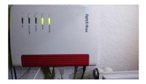
Nach Montage der Fritz-Box an beiden Geräten den LAN Port 1 mit dem Netzwerkkabel verbinden.
