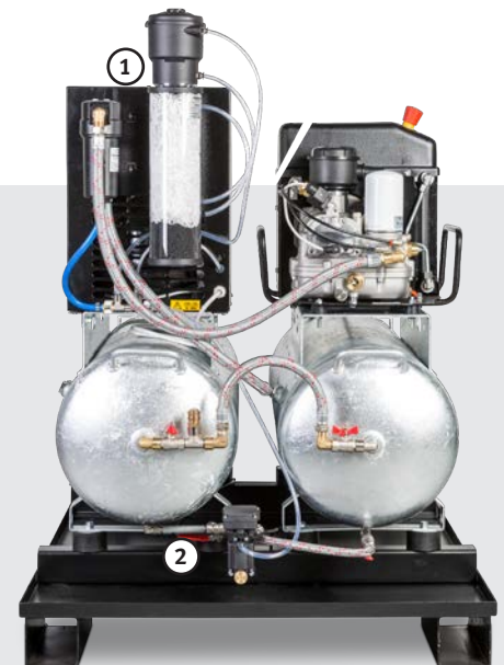
Ausstattung DUO KK zusätzlich mit: 1. Kondensataufbereiter zur Öl-Wasser-Trennung 2. Automatischer Kondensatableiter verbaut am Kondensatablass der Druckluftbehälter, Kondensatableitung ohne unnötigen Druckverlust
