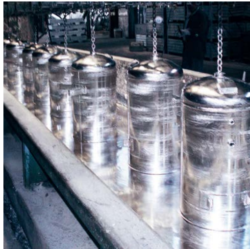
Feuerverzinkung für lange Lebensdauer
