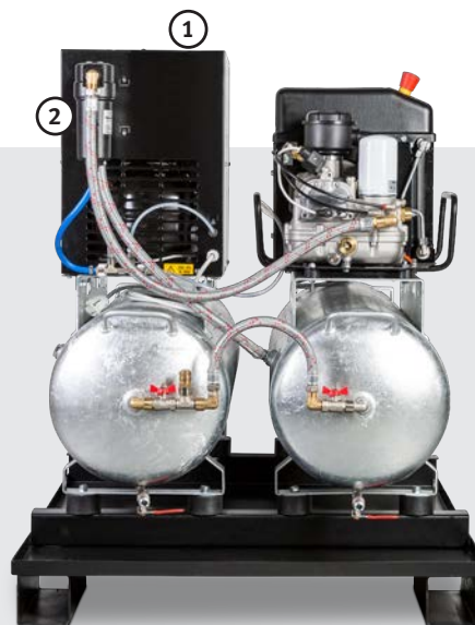
Ausstattung DUO K zusätzlich mit: 1. Kältetrockner mit integriertem automatischem Kondensatableiter: Drucktaupunkt 5 °C, Druckluft-Eintrittstemperatur 35 °C, Kühllufttemperatur 25 °C 2. Feinfilter als Vorfilter vor dem Kältetrockner zum Abscheiden von Kondensat und festen Verunreinigungen mit Partikeln bis 1 µm (Druckluftqualität nach ISO 8573-1)
