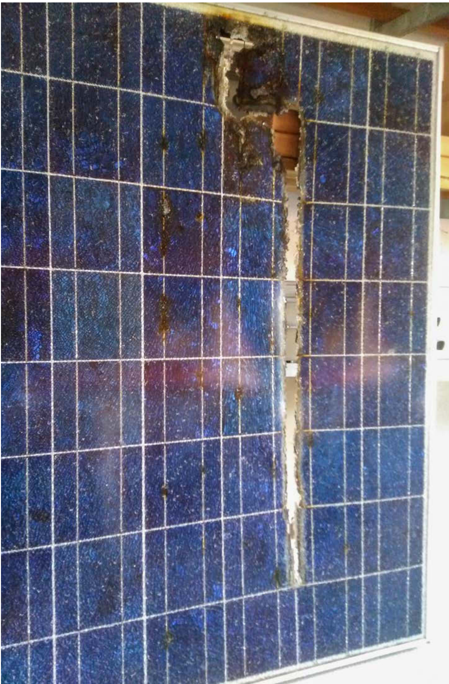
Bei diesem Modul haben sich kleine, kaum sichtbare Fehler in der Kontaktierung erst nach Jahren zum handfesten Brand ausgewachsen.
