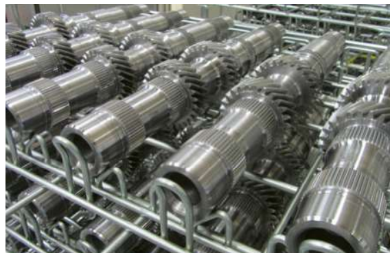
Imagen 1: Proceso apto para largas series - como, por ejemplo – el mecanizado de cajas de cambio, en una máquina transfer con la herramienta SNAP-X.
