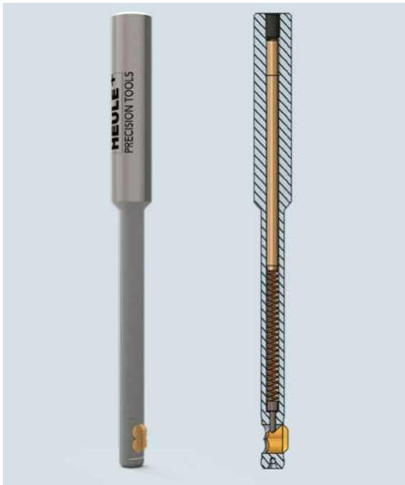
Imagen: SNAP5 - La denominada geometría "B" de la cuchilla es más compleja en cuanto a la fabricación. Sin embargo, su capacidad de guiado optimizada justifica este diseño para este tamaño de herramienta.
