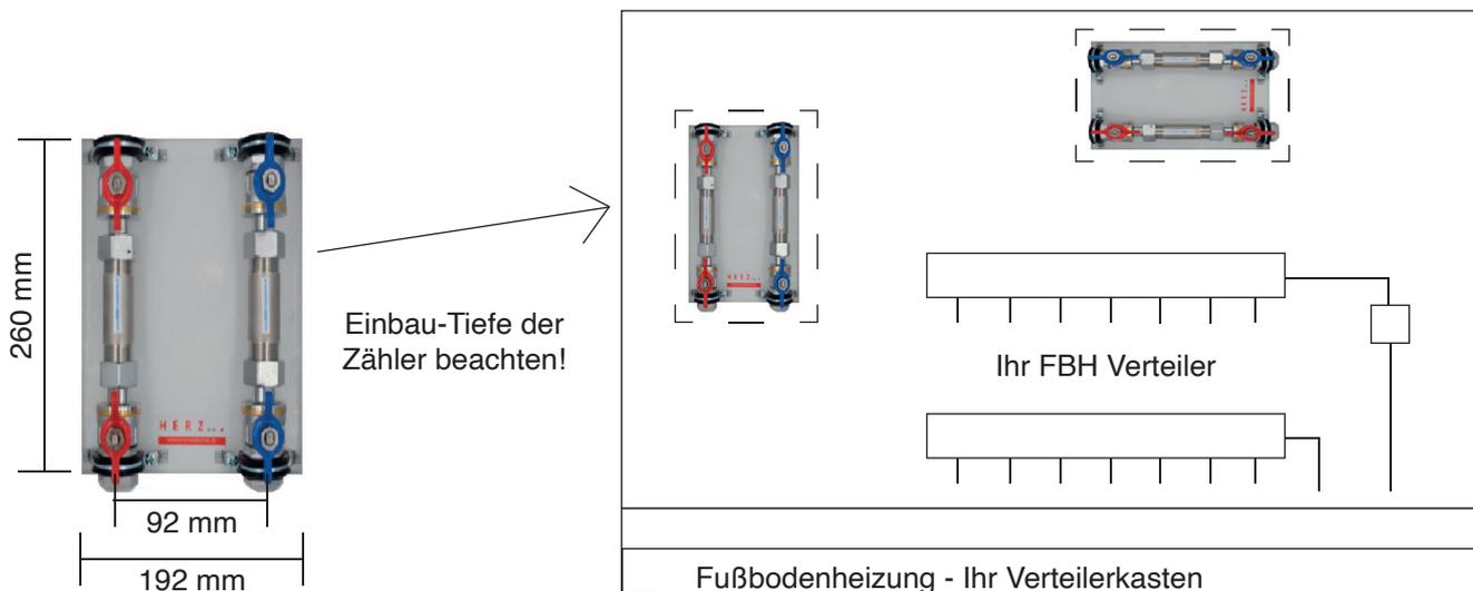
Wasserzähler-Einbauset Kalt/Warm mit 4 DVGW Kugelhähnen 3/4" und integrierter WZ-Verschraubung, Passstück 110 mm x G 3/4", mit Montageplatte und vier montierten Einzelschellen für eine einfache Befestigung in den Verteilerkästen.
