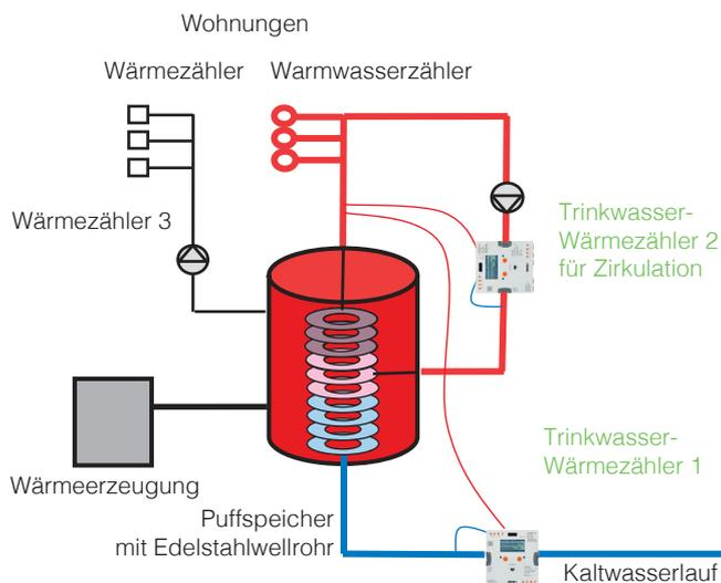
Unser **Superflow-U® Typ S4** Trinkwasser-Wärmezähler ermöglicht die Energieerfassung für besondere Anwendungen (z.B. Einsatz bei Hygiene-Speicher) nach der Heizkostenverordnung.
