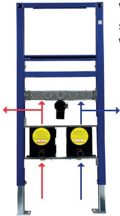
Waschtisch-Messblock als fertige Montageeinheit zur einfachen Befestigung in Vorwand-Ständer-systemen (z. B. Geberit, Viega oder TECE) mit hochwertigen Absperrventilen 3/4" und KOAX 2" Wasserzählerunterteilen (Hamburger Modell) inkl. Isolierung und Bauschutzkappen.
