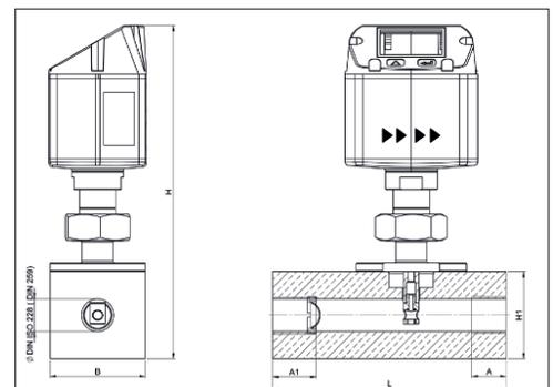
Der Sensor kann aus dem Messblock entfernt und gereinigt werden.
