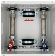
aus Stahlblech weiß beschichtet, je Zählerstrecke mit DVGW-Kugelhahn aus Messing 3/4" IG oder aus Edelstahl 3/4" IG und integrierter Zählerverschraubung sowie Edelstahl-Zählerpassstück 110 mm x 3/4" und Edelstahlverschraubung 3/4" zur einfachen Montage unter Waschbecken.
