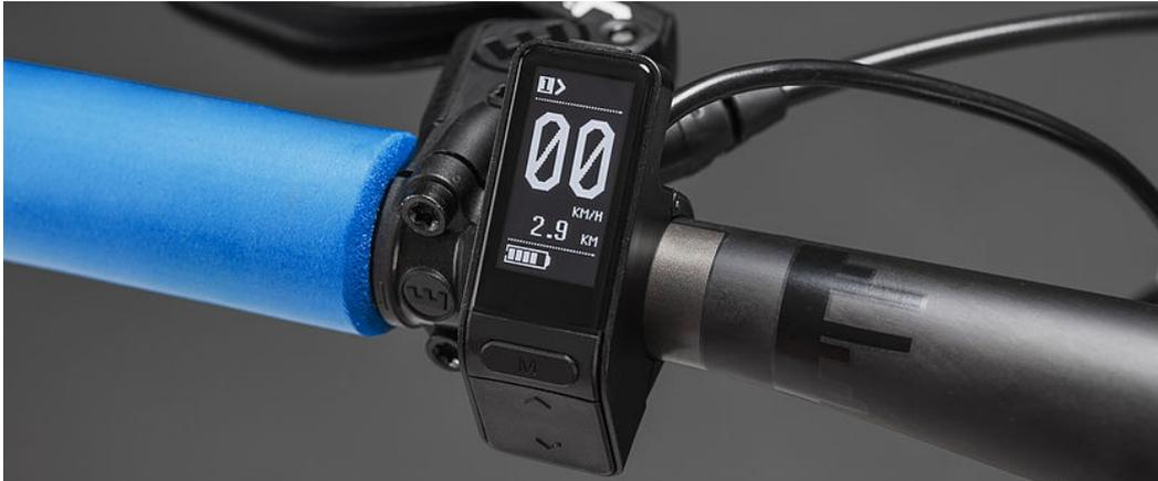
Anstelle eine LC-Displays kommt hier modernste OLED-Technologie zum Einsatz. Egal aus welchem Blickwinkel man es betrachtet - perfekte Ablesbarkeit ist stets gewährleistet.
