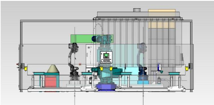
**Planung und Entwicklung** einer Jigless Schweißzelle mit Yaskawa Robotern für Rahmenteile max Abmaße ( 3500x1500 ) Gewicht 250 Kg Bauteile sind vorgeheftet.
