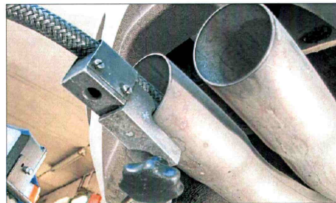
Ein Messschlauch eines Geräts zur Abgasuntersuchung für Dieselmotoren steckt im Auspuffrohr eines VW Golf in einer Werkstatt. Foto: Patrick Pleul
