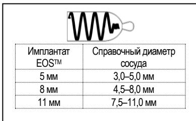
Рисунок 1. Размеры устройства
