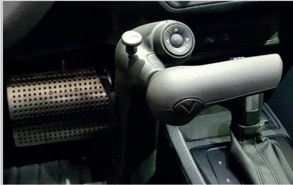
Handgasgeräte ermöglichen Körperbehinderten das bequeme und sichere Führen eines Kraftfahrzeugs. Die technischen Möglichkeiten für derartige Umbauten sind fast grenzenlos.
