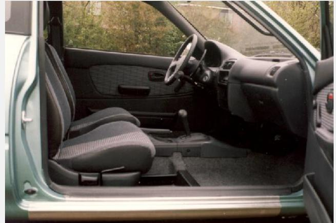
Eine Sitzschienenverlängerung erleichtert den Ein- und Ausstieg für Menschen mit Behinderungen und Menschen, die groß gewachsen sind. Durch diese Umrüstung werden mehr Beinfreiheit sowie eine komfortablere Sitzposition erreicht. Mithilfe der Sitzschienenverlängerung kann der gesamte Autositz weiter nach vorne oder nach hinten adaptiert werden, je nach Fahrzeugtyp bis zur Rückbank.
