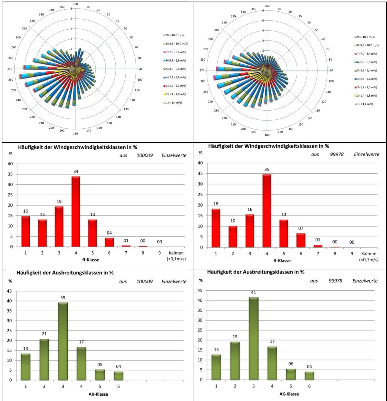
Abbildung 11: Windrosen und Häufigkeitsverteilungen von Windgeschwindigkeit und Ausbreitungsklasse an der GK-Koordinate 4402500 / 5485500, berechnet auf Basis von 120 Clustern (links) und 269 gleichverteilten Clustern (rechts).
