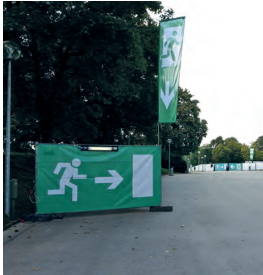
Abb. 30: Ergänzende Kennzeichnung eines Fluchtweges durch eines Flagge
