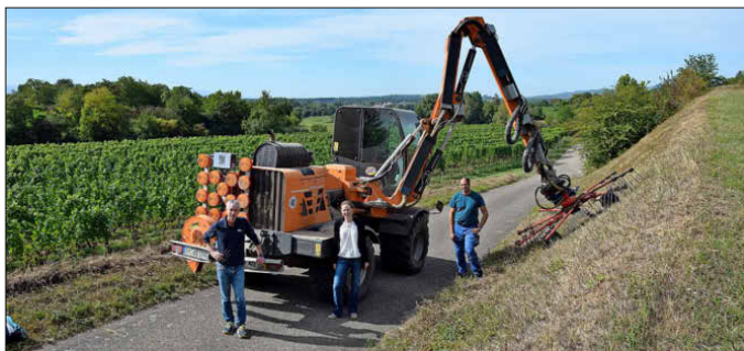
Zwölf Meter lang ist der Gelenkarm des selbstfahrenden Böschungsmähers. Landwirt Oliver Schwarz (rechts) zeigt Barbara Degenhart von der Stadt Emmendingen (Mitte) und Martin Geisel vom Landschaftserhaltungsverband (links) die Funktionsweise.
