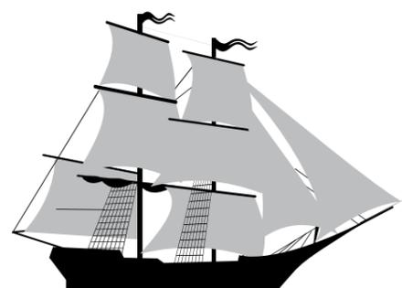
Brigg: Ein zweimastiges Segelschiff mit Rah- und Schratsegel.
