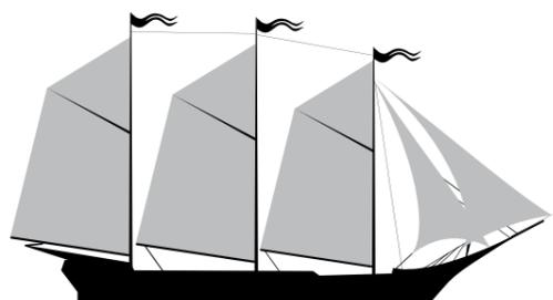
Schoner: Ein Segelschiff mit bis zu fünf Masten.
