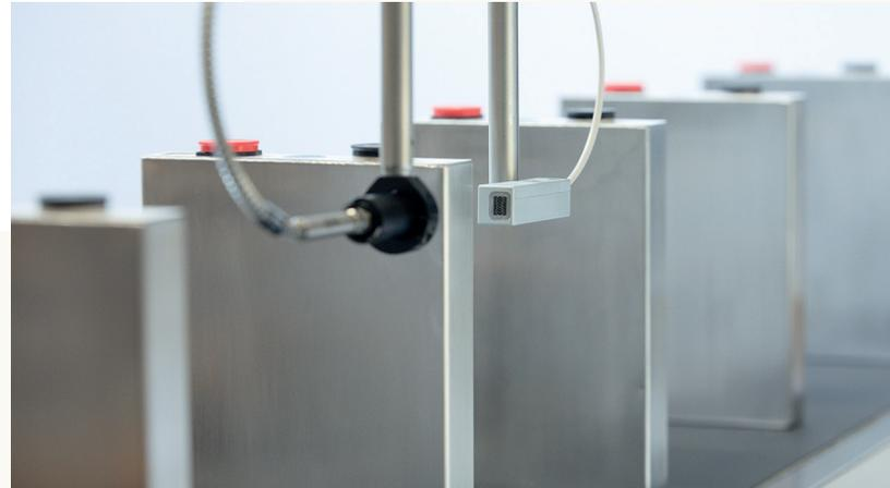
auf Kontakt zum Prüfling verzichtet werden, was erhebliche Vorteile in der Automatisierbarkeit mit sich bringt. Mit anderen Worten: Es braucht kein Gel oder Wasser auf die Oberfläche aufgetragen werden, was natürlich ein enormer Vorteil ist, wenn die Prüfung rasch von Statten gehen muss oder zum Beispiel auf einem Förderband das Produktionsgut schnell vorbeifährt, aber trotzdem auf innere Qualität untersucht werden muss.
