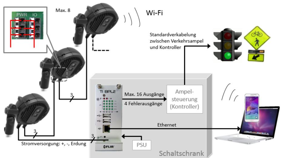
**Abbildung 3.7** Systemarchitektur einer TraftOne in einer Netzwerkinstallation mit Powerline Communication via TI-BPL2-Schnittstelle mit Daisy-Chain-Topologie
