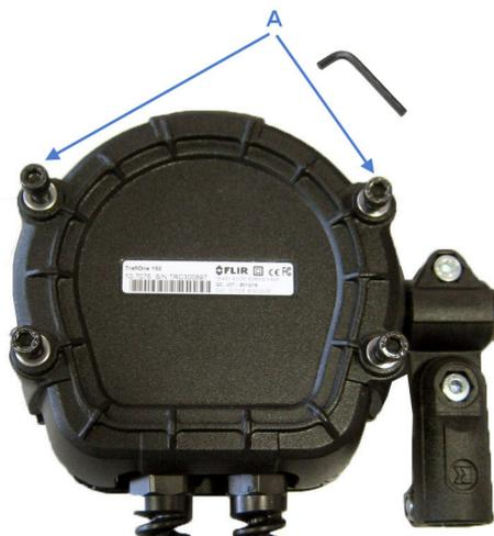
2. Positionieren Sie den Regenschutz hinten auf der TrafiOne, sodass die Löcher im Regenschutz auf die Löcher in der TrafiOne passen.
