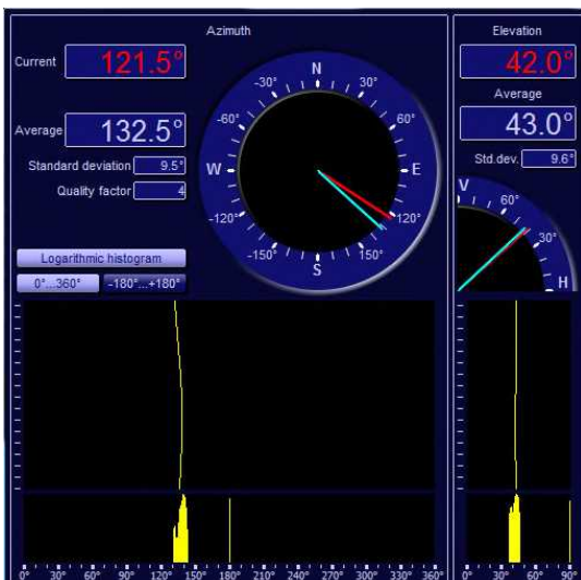
Exemple montrant l'azimut et l'élévation de l'onde de ciel sur la bande de HF
