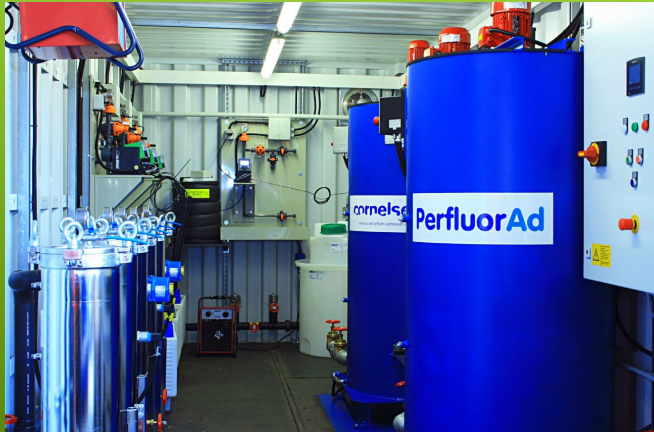
Mobile PerfluorAd-Löschwasserreinigungsanlage (MLB) (eingebaut in 20'-Container)
