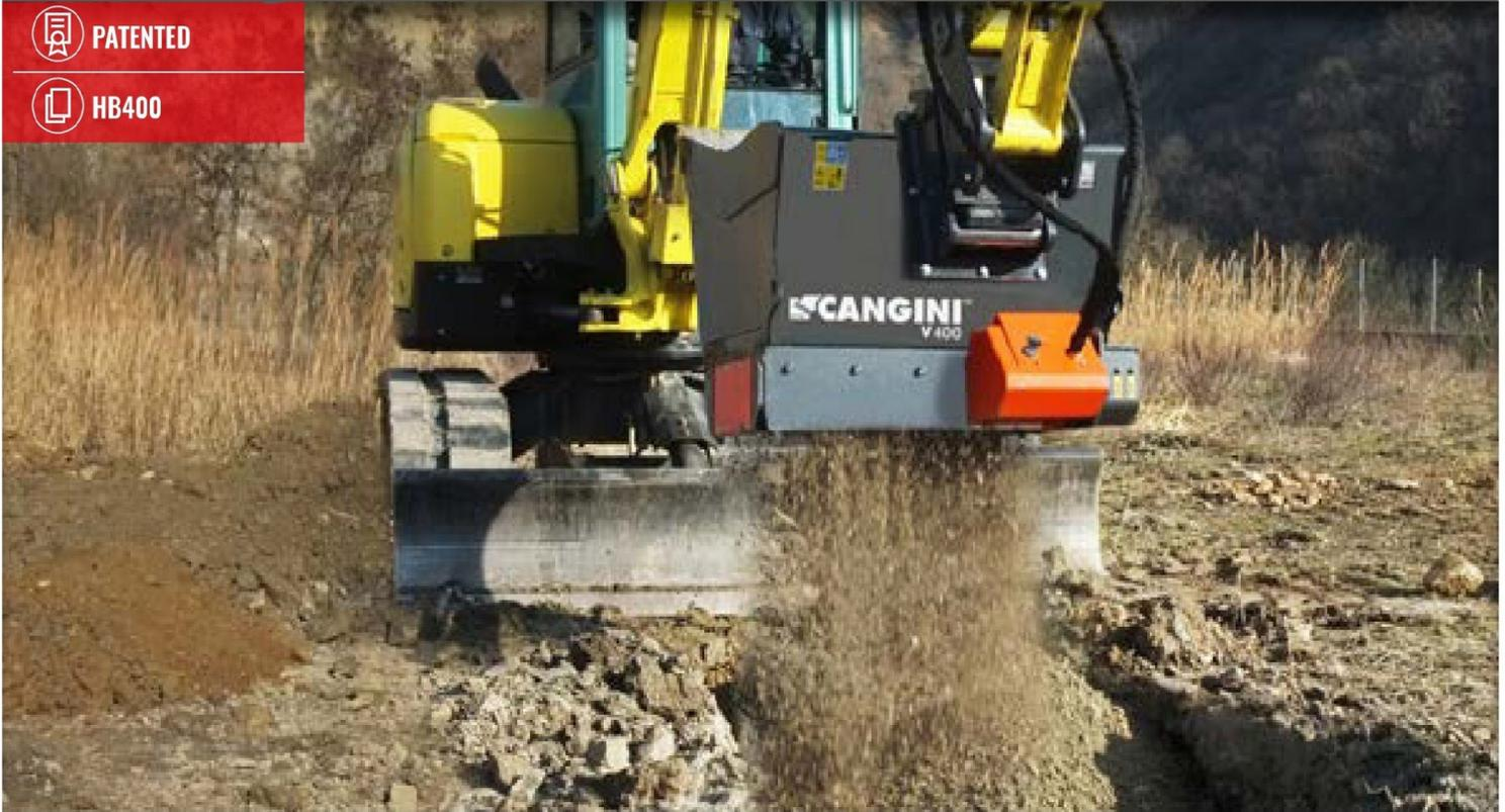
Hydraulischer Sieblöffel zum Anbau an Mini- und Midibagger. Die Siebwellen sind aus 400 HB. Zum Sieben und Trennen von Abbruch- und Aushubmaterial, aber auch zum Vermischen von Erde und Torf. Siebweiten von: 0-20 mm bis 0-35 mm in der Standardkonfiguration. Auf Anfrage sind auch individuell gefertigte Wellen erhältlich.
