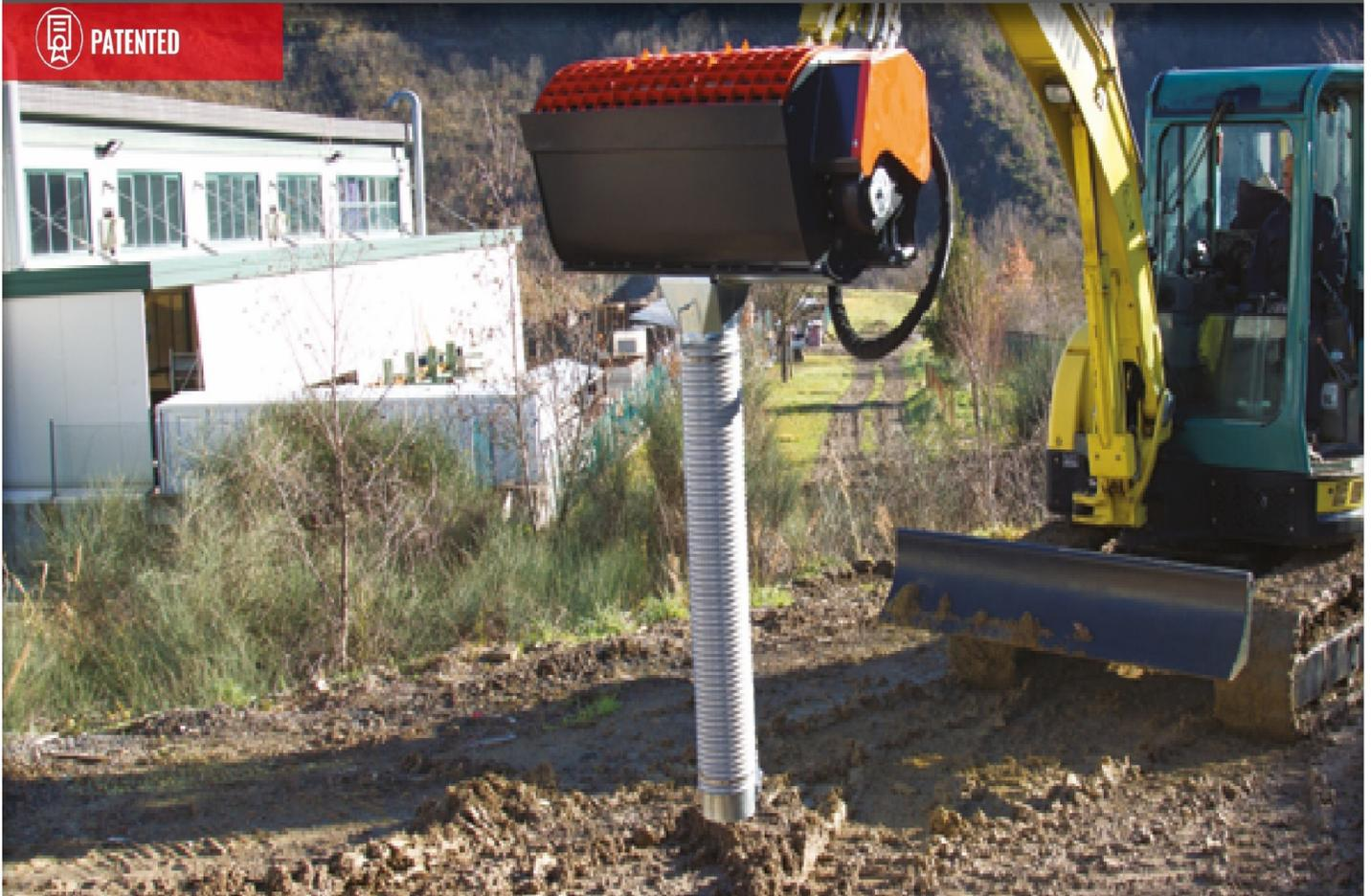
Die Kraftübertragung erfolgt mit einem Untersetzungsgetriebe, das eine hohe Leistung sicherstellt und einen wesentlich geringeren Wartungsaufwand hat als ein Kettenantrieb. Überdruck- und Übermengenventil sorgen auch unter schwierigsten Bedingungen für Effizienz und Zuverlässigkeit.
