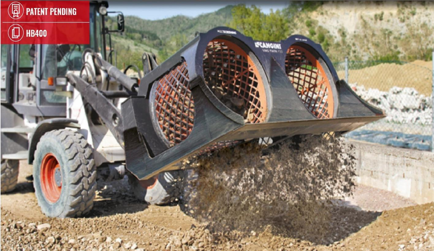
Die neuartige Siebtrommel "Multiscreening" Frontanbau, mit zwei Doppeldrehende Körben in einen einzige Aufbau kombiniert, ist für das Sieben von Erdbewegung Material geeignet. Die Einstellung der Korngröße mit hydraulischer Steuerung in der Kabine, erlaubt die Auswahl der Siebgröße von einem Minimum von 25 mm bis maximal 60 mm. Da kein zeitaufwendiges Auswechseln von mechanischen Elementen notwendig ist, erhöht dies die Produktivität.
