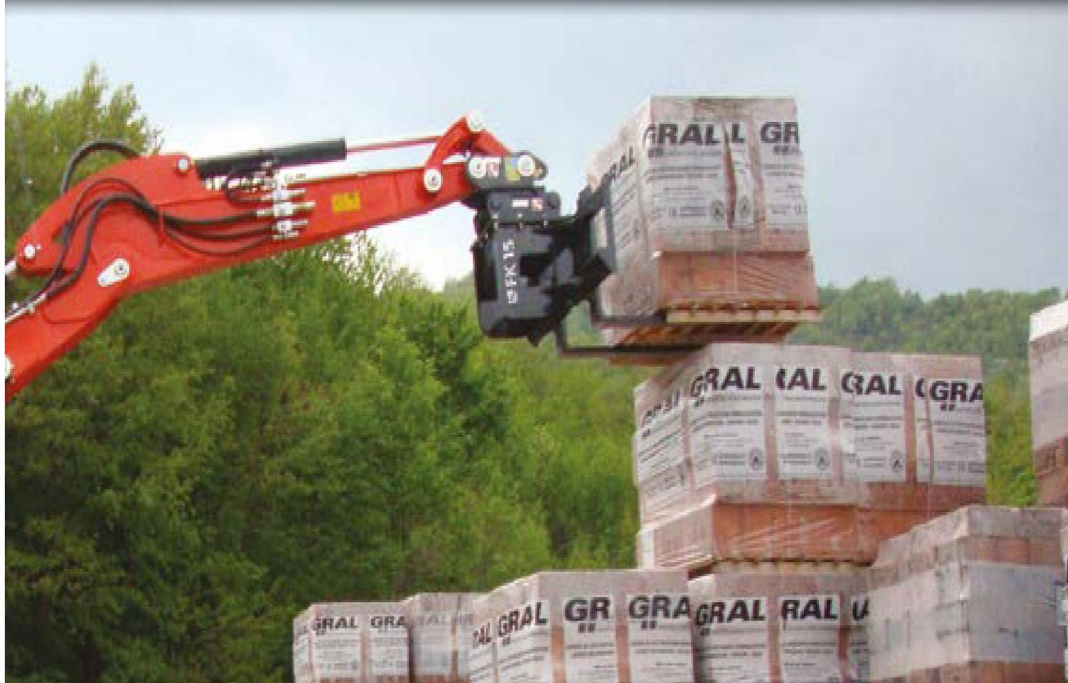
Dieser Aufbau der Palettengabel kann auch auf Bagger angewendet werden. Somit können die Lasten in Positionen gebracht werden, die sonst nur schwer erreichbar sind.
