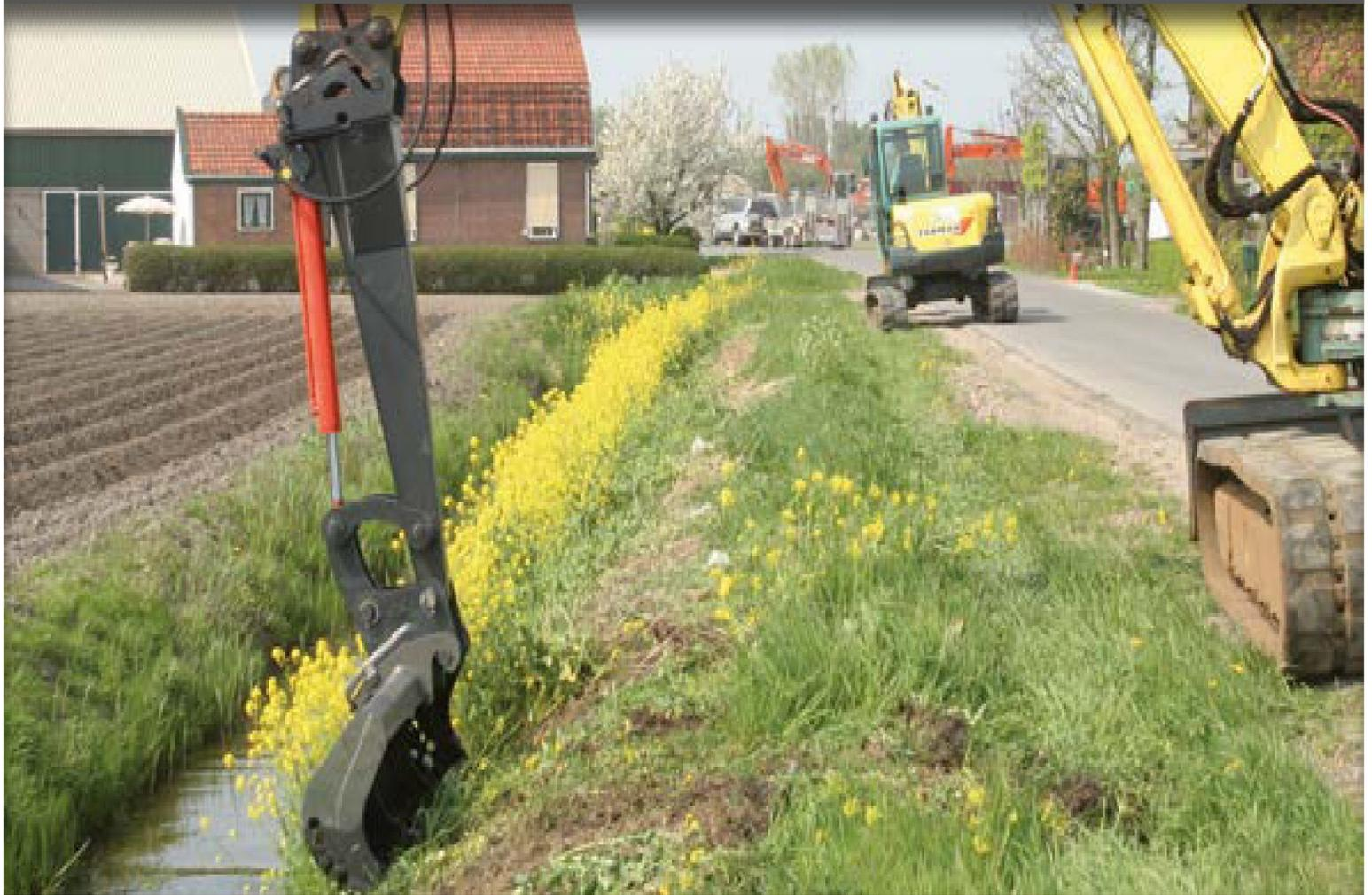
Überall dort unerlässlich wo der Aktionsradius der Maschine in der Standardkonfiguration nicht ausreicht. Die Ausleger-Verlängerung wird mit unvollständiger Maschinen Zertifizierung geliefert, gemäß Anhang II-B Richtlinie 2006/42/CE. Das Zertifizierungsverfahren liegt in der Verantwortung des Benutzers, nachdem es an der Grundmaschine verbunden worden ist und vor seinem regulären Betriebseinsatz.
