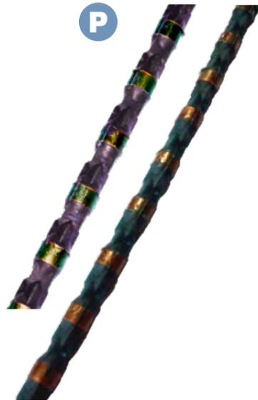
Hilo diamantado sinterizado para sierras de hilo. El diámetro de las perlas puede variar entre 11mm a 15mm. El número de perlas diamantadas por metro dependerá de la velocidad de corte y la potencia de la sierra. Tipos de hilos:
