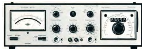
Abb. 24: B&K 1023; spannungssteuerbarer VCO, 10Hz – 20kHz, 0.5mV/Hz (lin) oder 1V/Oct. (log), mit FM-Option. Schaltpläne von www.ArtekManuals.com .
