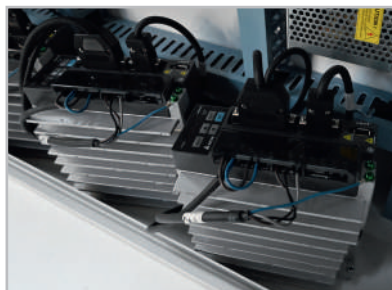
Equippé d'un servomoteur sur les 3 axes · Limite le risque de perte de pas durant l'usinage et le changement d'outils
