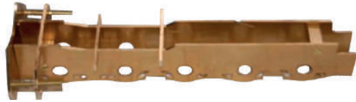
Fig . : Pièce usinée en laiton avec Easymill Hobby sur MH 25 CNC
