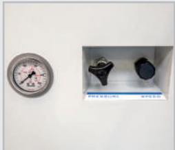
· Réglage de la pression hydraulique avec manomètre de contrôle
