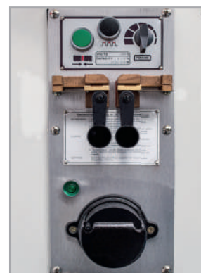
• Tous les modèles sont équipés d'une unité complète de soudage de lame
