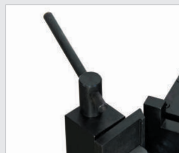
• Mors de serrage excentrique pour un blocage rapide de la pièce à cintrer
