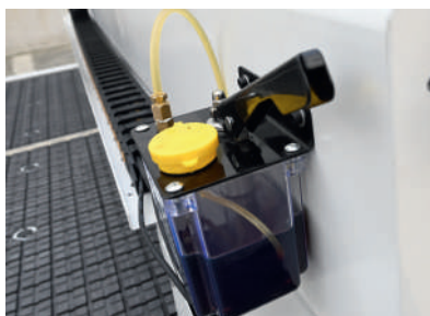
Système de lubrification · Par bain d'huile des guides linéaires
