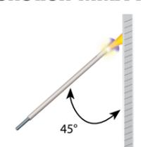
Le mode de soudage MMA Pulsé convient à des applications en position verticale montante et passe de racine. Le pulsé permet de conserver un bain froid tout en favorisant le transfert de matière.
