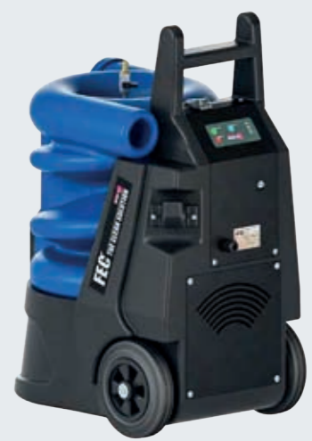
BINZEL 073715 • 230V / 1~, 1100 W • 230 m³/h max • 190 mbar max • 25 kg, 590 x 425 x 825 mm • 76 db • Filter auto cleaning system - Système de nettoyage automatique du filtre - Automatische Filterabreinigung Filtre Classe M, EN 60335-2-69 included : 5 m, Ø50
