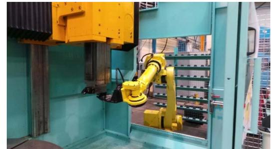
Robotique : robot changeur d'outil
