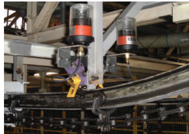
Automobilindustrie: Schmierung von Rollen und Schienen hängend schienengeführter Förderbänder.
