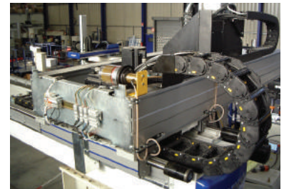
Roboterindustrie: Schmierung von Kugelführungen.
