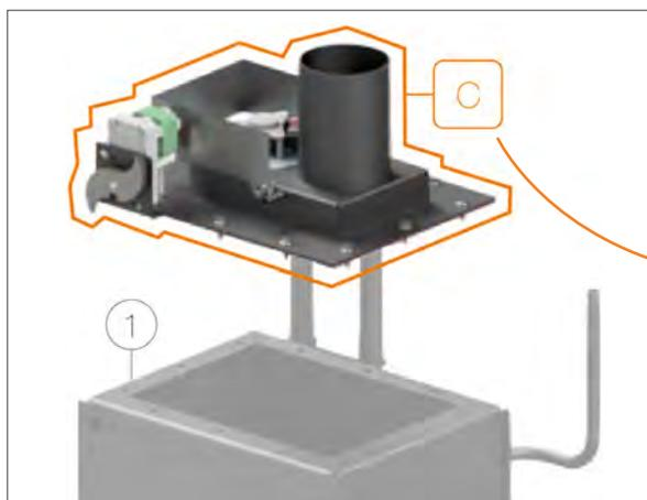
Ersatzteile, die orange eingrahmt und mit Buchstaben gekennzeichnet sind, bilden Bauteilgruppen. Diese können als ein Ganzes bestellt werden oder auf der in der Tabelle vermerkten Seite nachgeschlagen werden, um Einzelteile zu bestellen.
