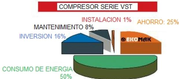
Controlados por un convertidor de frecuencia, los compresores EKO -VST pueden ahorrar hasta un 36% de la energía eléctrica lo que significa un ahorro total de hasta un 25% sobre el gasto total.
