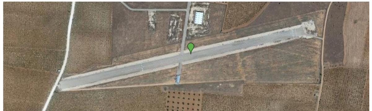
La pista principal mide 650m de longitud por 25m de ancho, la pista auxiliar es de 150m y ambas están asfaltadas.
