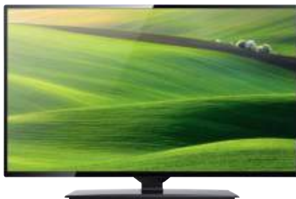
12 - 24 Volt-Versorgung über Batterie und 230 V aus dem Stromnetz. Auflösung (Pixel) 1.920 x 1.080.
