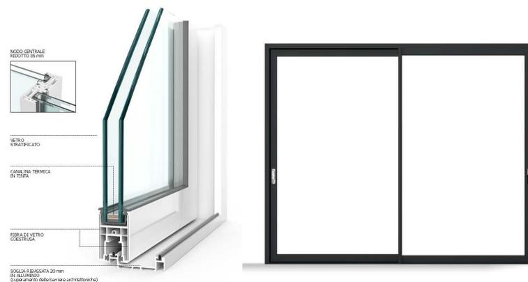
I serramenti scorrevoli a due ante in linea, saranno di produzione *Nobento* serie *Genio* realizzati con telaio da 70 mm con rinforzo termico in PVC espanso ed ante da 46 mm a tre camere con rinforzo integrato in fibra di vetro. L'apertura sarà in linea con spazzolini di tenuta e con vetrata isolante bassa emissiva antinfortunistica interna ed esterna composta da lastra stratificata 4+1+4 silent, intercapedine 12mm con gas argon e lastra stratificata 3+1+3.
