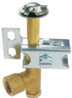
Art.-Nr.: 504004 Zündbrenner SIT Typ "SIT 100" 2-flammig Erdgas 25mbar
