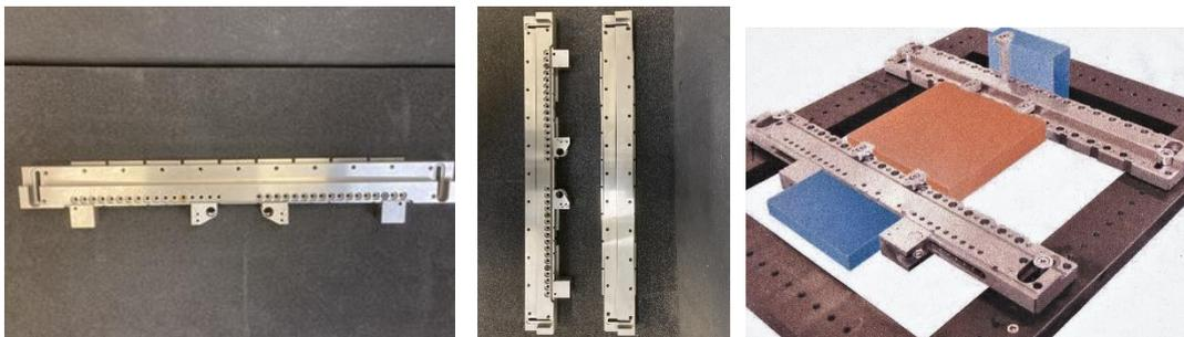
Artikelzustand NEU, Stahl 1.2083 gehärtet, 56 Rockwell
