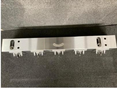
Artikelzustand NEU, Abstand zwischen Spannaufnahmen 100mm, **Spanntechnik stärkste auf dem Markt**, Stahl 1.2083 gehärtet, 56 Rockwell, Maße: 60x 65x 550 mm
