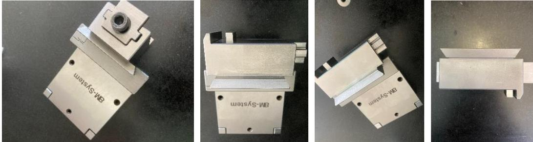
Artikelzustand NEU, Stahl 1.2083 gehärtet, 56 Rockwell
