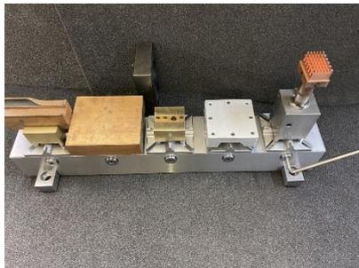
Artikelzustand NEU, Abstand zwischen Spannaufnahmen 100mm, **Spanntechnik stärkste auf dem Markt**, Stahl 1.2083 gehärtet, 56 Rockwell, Maße: 560mm x 80mm
