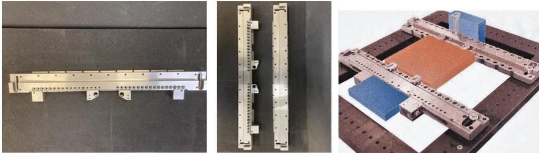
Artikelzustand NEU, Stahl 1.2083 gehärtet, 56 Rockwell
