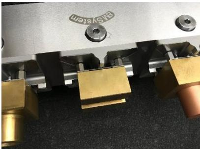
Artikelzustand NEU, Abstand zwischen Spannaufnahmen 100mm, **Spanntechnik stärkste auf dem Markt**, Stahl 1.2083 gehärtet, 56 Rockwell
