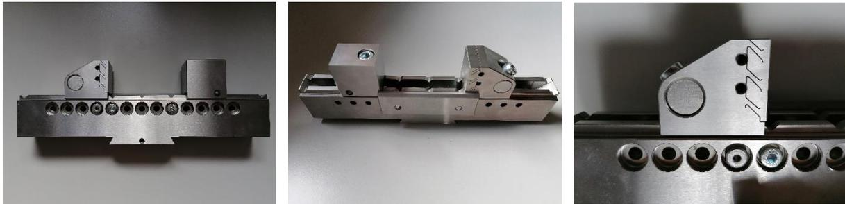
Artikelzustand NEU, Stahl 1.2083 gehärtet, 56 Rockwell
