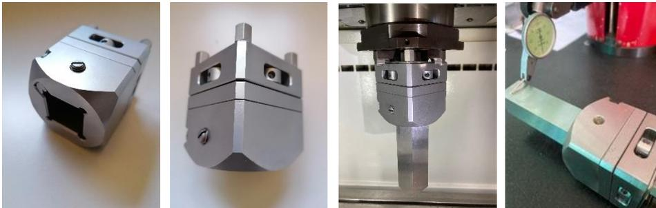
Artikelzustand NEU, 25er Vierkanthalter mit Nivellierung für EROWA Spannsystem.
