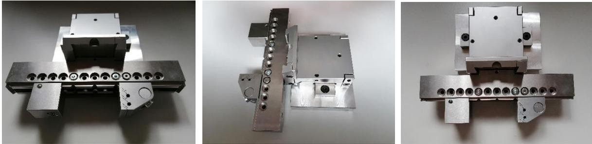
Artikelzustand NEU, Stahl 1.2083 gehärtet, 56 Rockwell
